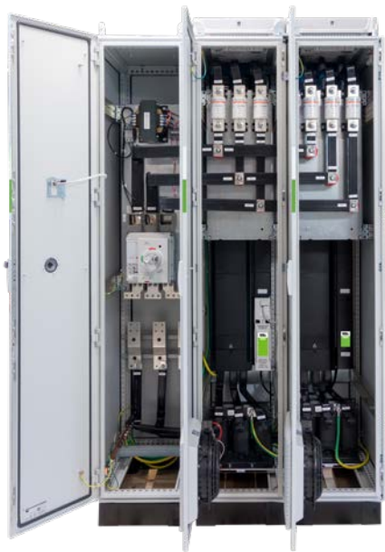
De DFS frequentieregelaar van Nidec is speciaal ontwikkeld voor het regelen van grote vermogens tot 2,8 MW.
